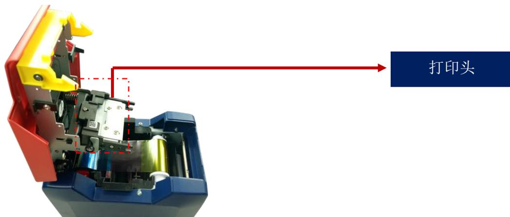
第 3 步：观察打印头两侧安装结构。
