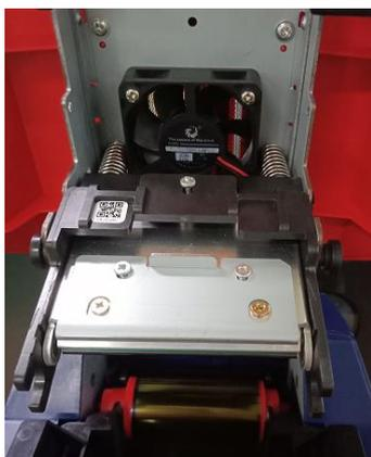
第 6 步: 在打印机驱动程序中, 把新打印头序列号录入, 更换打印头时, 需要把新打印头的条码号输入。不修改可能导致打印异常。
